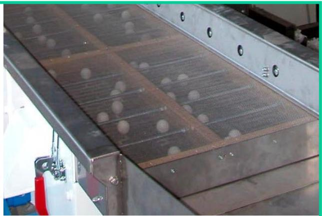
**TELA DI VAGLIATURA** facilmente smontabili e sostituibili manualmente senza l'ausilio di attrezzi. Reti inox, barrotti longitudinali o lamiere forate anche in esecuzione speciale (esempio asole, fori ovali, ecc.). Su richiesta i telai vengono forniti completi di sistema di disintasamento automatico dei fori a mezzo palline in gomma certificata per alimenti.
